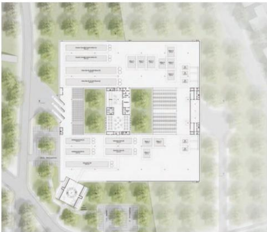
Bild 3: Zentraler Arbeitsbereich flankiert von zwei Innenhöfen als Entscheidungs- und Steuerzentrale der Fabrik. Quelle: L. Wieloch, 2014
